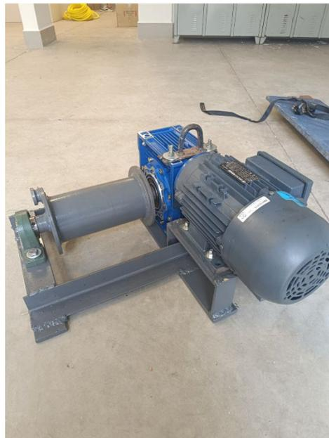
Figura 12: Motor de tração 1
