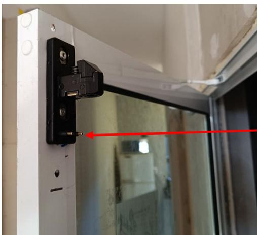
Chifre de contato do circuito do trinco.
